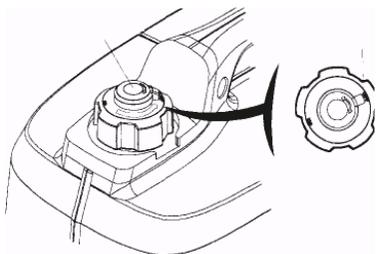
2. Поверните выключатель двигателя в позицию «ON».
