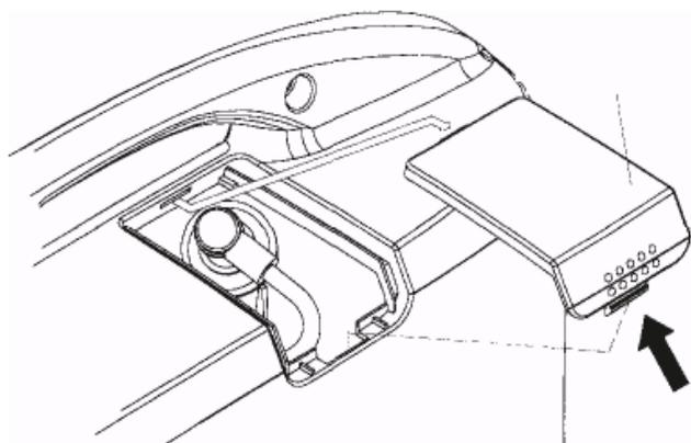
2. Снимите колпачок свечи зажигания.
