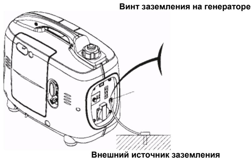
1. Убедитесь, что подключаемое оборудование исправно, выключено и его электрические характеристики не превышают номинальных характеристик генератора. Убедитесь, что оборудование, которое будет использоваться выключено, подключите его к розетке генератора. Запустите двигатель генератора (раздел 5).
