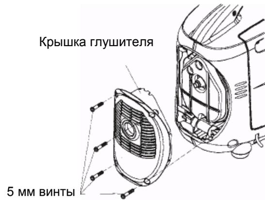
2. Выкрутите три и снимите глушитель, искрогаситель и прокладку глушителя.
