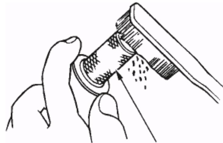
4.Проверьте прокладку глушителя, замените если она повреждена. Установите прокладку глушителя, искрогаситель, глушитель и защитный кожух глушителя в обратной последовательности разборки
